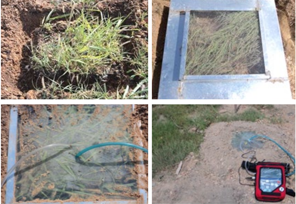
Figura 31 Vista do processo de cravação da placa em uma camada cultivada da CE e medição do fluxo de gás.
