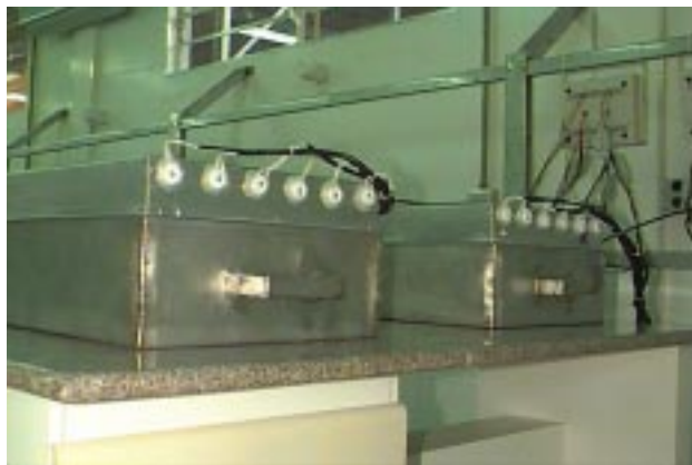
Figura 7.14 - Vista geral de unidade de laboratório utilizada para desinfecção com radiação ultravioleta.
