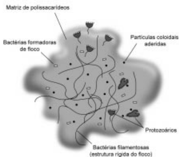
Figura 5.2 - Representação esquemática de um floco de lodo ativado
