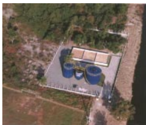
Figura 4.20 - Foto aérea da ETE Meaípe, UASB + BFs separados, 6.500 hab ou 13 L/s. Cortesia: CESAN
