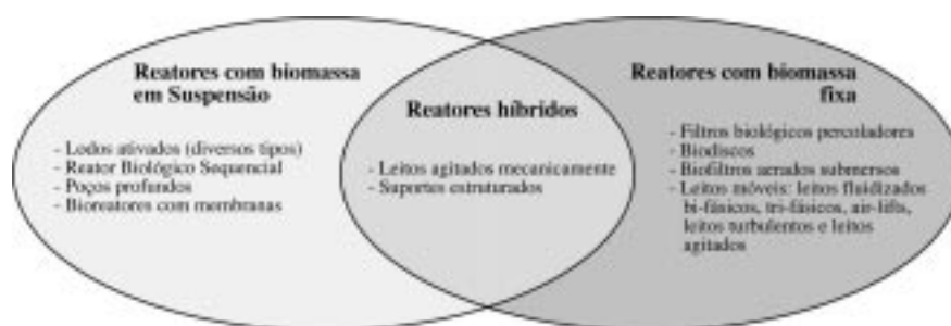
Figura 4.1 - Classificação moderna dos processos mecanizados de tratamentos aeróbios, com relação ao estado da biomassa (adaptado de LAZAROVA e MANEM, 1993)
