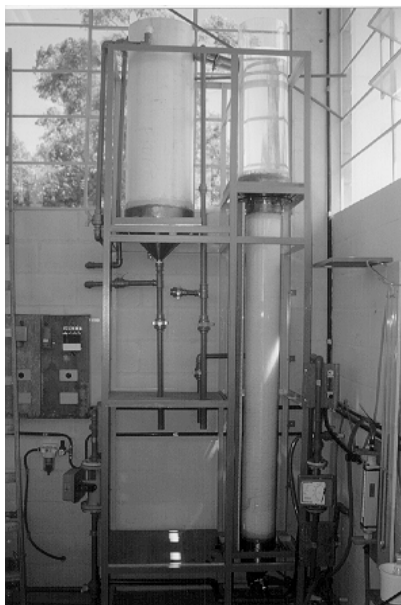
Figura 2 - Foto do reator de leito fluidizado
