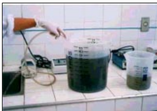
Fig. 1 – Remoção do sobrenadante após o período de sedimentação (procedimentos "b" e "c")
