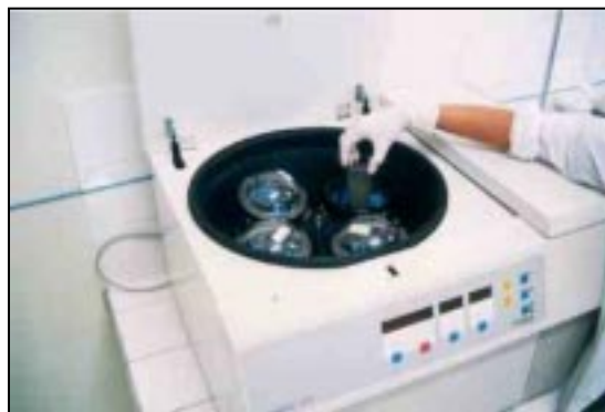
Fig. 17 - Concentração da amostra por centrifugação (procedimentos "d" e "g")
