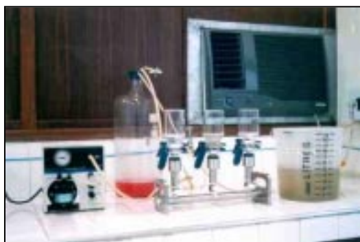
Fig. 38 – Filtração de 1 L da amostra em membrana de 47 mm e 8 µm. (procedimento “a”)
