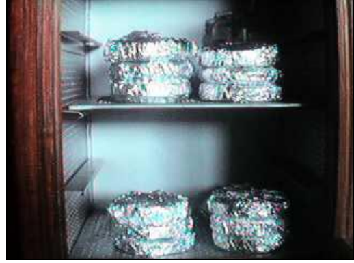
Fig. 23 – Placas envolvidas em papel alumínio e incubadas a 28 °C, durante 28 dias (procedimento “l”)
