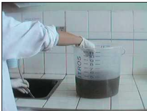
Fig. 16 - Remoção do sobrenadante após o período de sedimentação (procedimentos "a" e "b")
