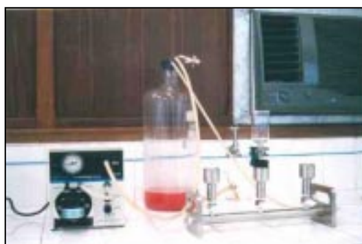
Fig. 41 – Filtração do sobrenadante em membrana de 25 mm e 8 µm (procedimento “d”)
