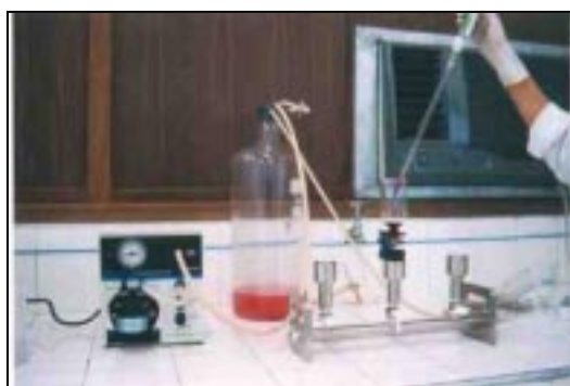
Fig. 42 – Adição de 5 mL do corante safranina, seguida de filtração (procedimento “e”)
