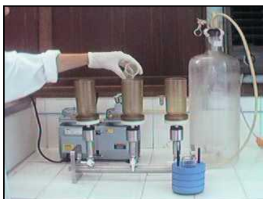
Fig. 20 - Filtração do sobrenadante (procedimento "j")
