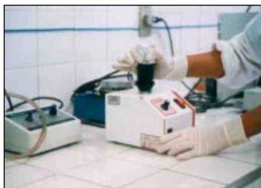
Fig. 4 – Homogeneização da amostra com Vortex (procedimentos "h" e "k")
