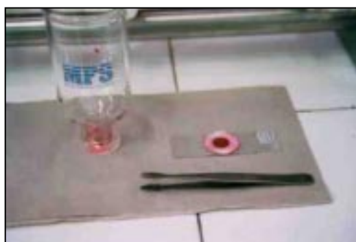
Fig. 37 – Lâmina contendo a membrana para visualização no microscópio (procedimento "f")
