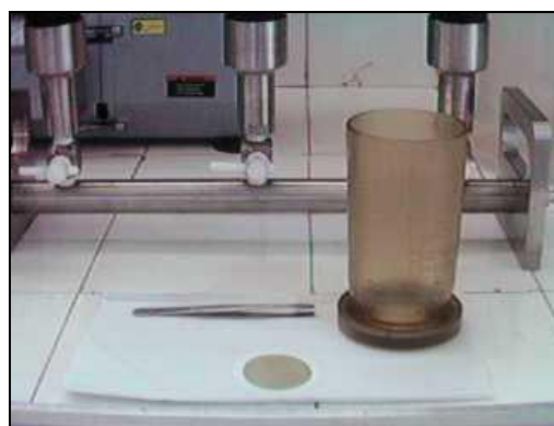
Fig. 21 - Membrana de 47 mm e 0,45 \mu de porosidade contendo os ovos
