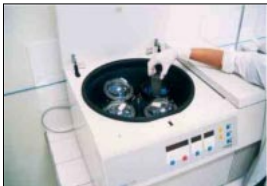
Fig. 32 – Concentração da amostra por centrifugação (procedimento "a")
