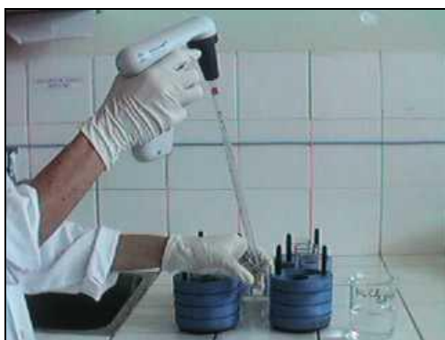
Fig. 18 - Adição de Cloreto de Sódio para clareamento da amostra (procedimento "e")
