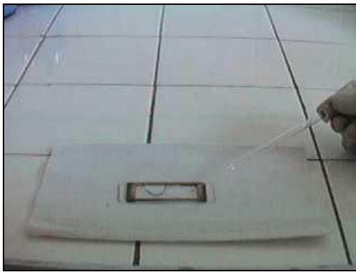
Fig. 24 – Transferência do material da placa de Petri para câmara de Sedgewick Rafter (procedimento “m”)
