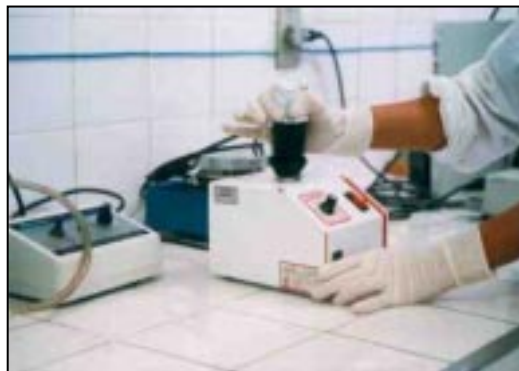
Fig. 33 – Homogeneização da amostra com Vortex (procedimentos "a" e "c")
